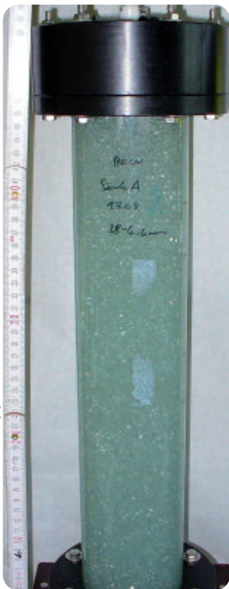
▲ Abb. 3: Versuchsanordnung zur Durchführung von hydraulischen Tests und hydrochemischen Anlagerungsversuchen an Glaskugeln und Filterkiesen
