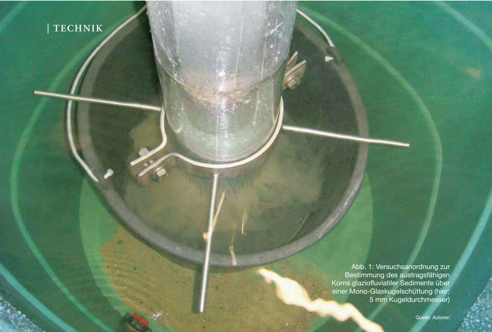
Abb. 1: Versuchsanordnung zur Bestimmung des austragsfähigen Korns glaziofluviatiler Sedimente über einer Mono-Glaskugelschüttung (hier: 5 mm Kugeldurchmesser)
