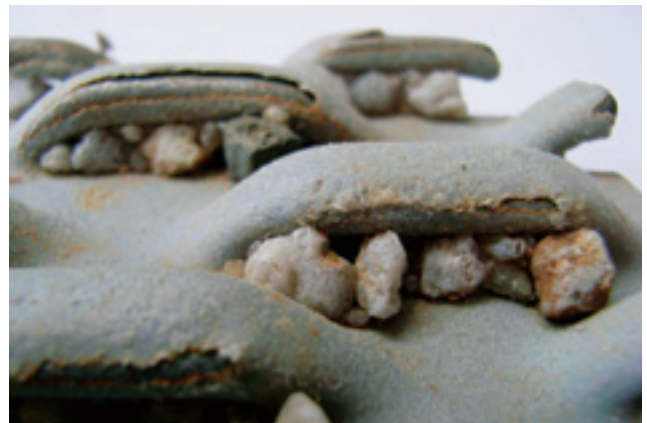
Abb. 2 Beispiel für verstopfte Filterschlitzöffnungen ohne Verockerung
