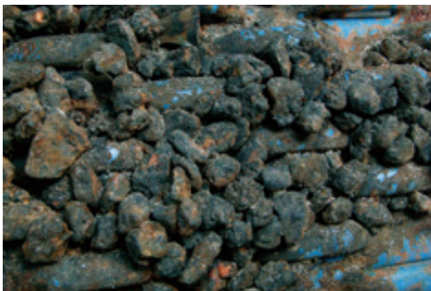
Abb. 3 Rückgebauter Schlitzbrückenfilter mit starker Manganverockerung
