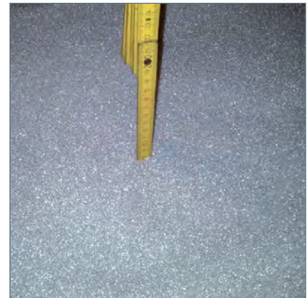
■ Abbildung 6: 80 mm Stützschrift, Glasbeads 0,75 - 1,0 mm; Foto: ETC, Burgau
