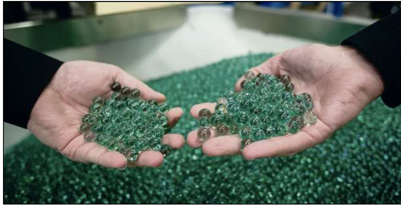
Kugeln für den Bau von Filtern bei der Wassergewinnung: Zwischen zwei und zwölf Millimeter Durchmesser sind machbar.
