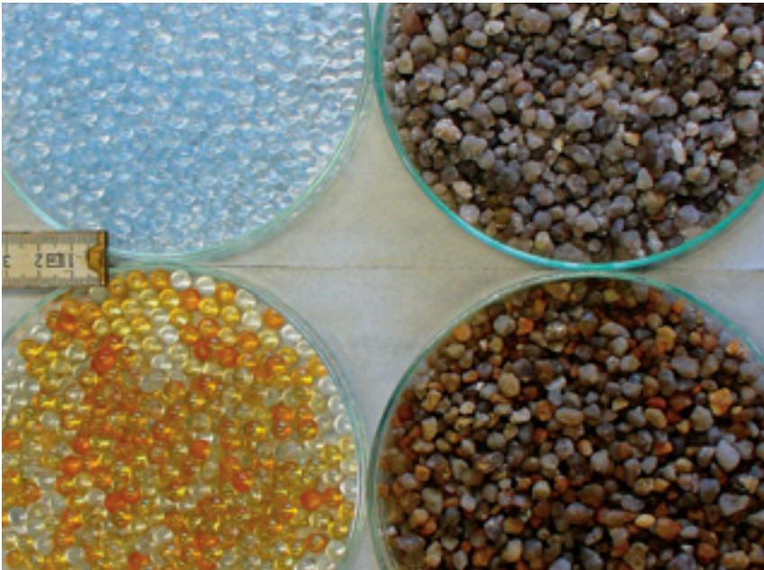
Abb. 7 Optischer Vergleich des Ausgangsmaterials und des teilweise inkrustierten Materials am Versuchsende nach der Probennahme
