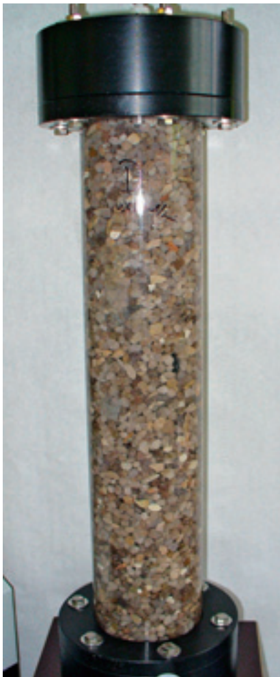
Abb. 4a+b Versuchssäulen mit Filterkies und Glaskugeln vor Versuchsbeginn
