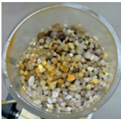
Abb. 5a+b Versuchssäulen geöffnet mit Filterkies (links) und Glaskugeln (rechts) nach Versuchsende
