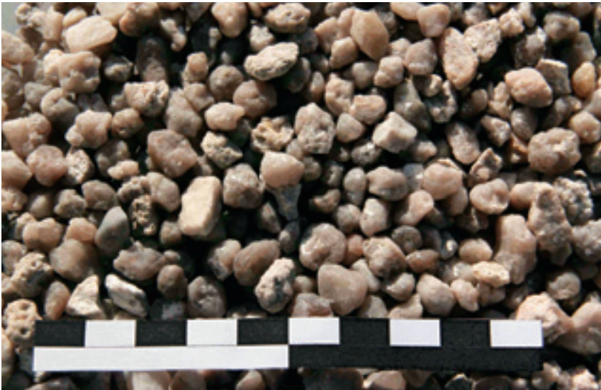
Abb. 3a Filterkies mit unregelmäßig geformten Körnern und mit Fe- und Schichtsilikat-Ablagerungen in den Vertiefungen der Kornoberflächen
