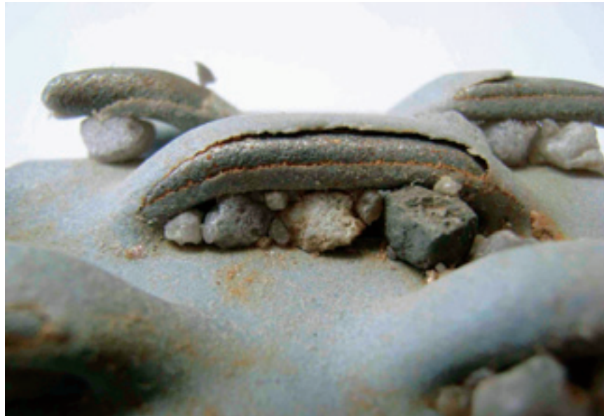
Abb. 2 Teile eines Schlitzbrückenfilters mit eingeklemmten Kiesbruchstücken und abgesplitterten Quarzkörnern in den Öffnungen
