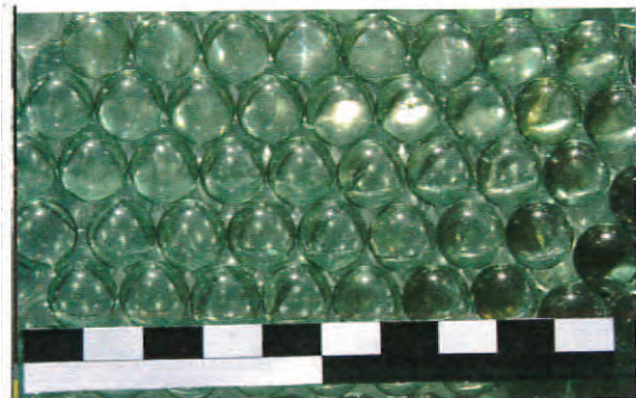
Abb. 7: definierter Porenraum von Glaskugeln
