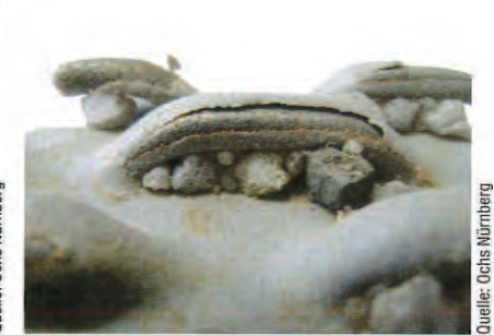
Abb. 3: Irreparable Kolmation von Filterschlitz durch Unterkorn
